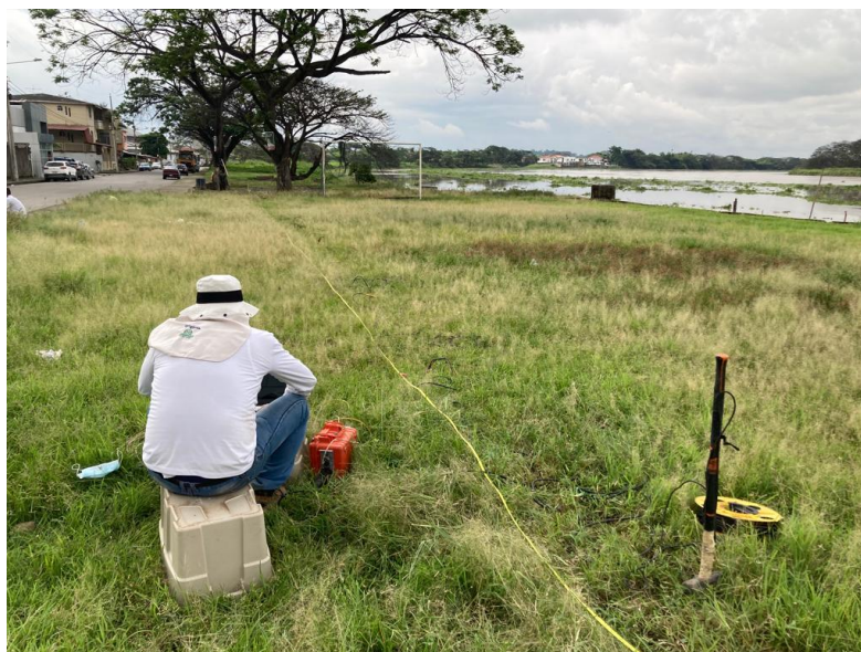
Foto 1. Ubicación del ensayo de medición de las ondas de corte Fuente: Trabajos de Campo
